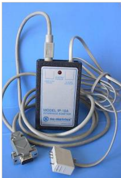
Figura 2.1.4 - Interfaccia IP 10-A e cavi per la connessione tra i contatraffico HI-STAR ed il computer
